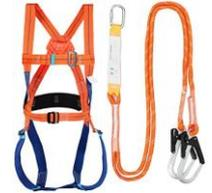
**LONGE AVEC ABSORBEUR D'ENERGIE** : Ce système de liaison est constitué d'une longe de 2 m de longueur maximale et de 2 connecteurs. Lorsqu'il est utilisé sur un point d'ancrage fixe, la longe doit impérativement comporter un absorbeur d'énergie. L'allongement de cet absorbeur lors de la chute nécessite de disposer d'un tirant d'air important qui doit être vérifié avant le début de l'intervention.
